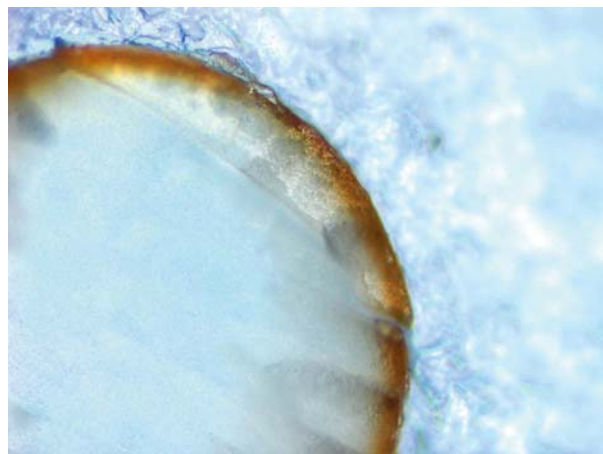
Зерно специального сорбента в разрезе
