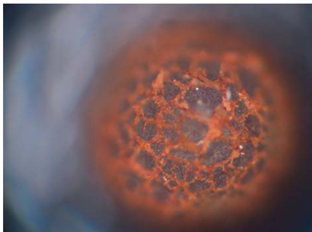
Зерно специального сорбента в разрезе
